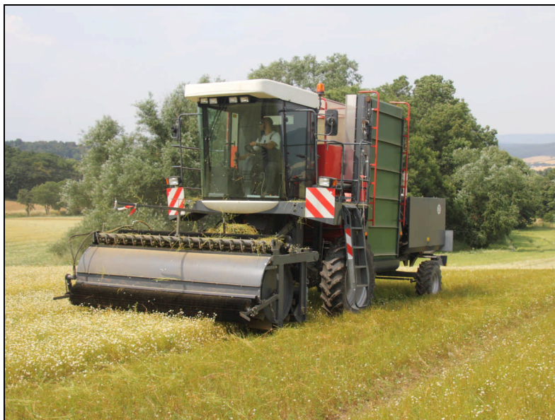
Bild 1: Erntemaschine für Kamillenblüten in der Erprobung 2013
