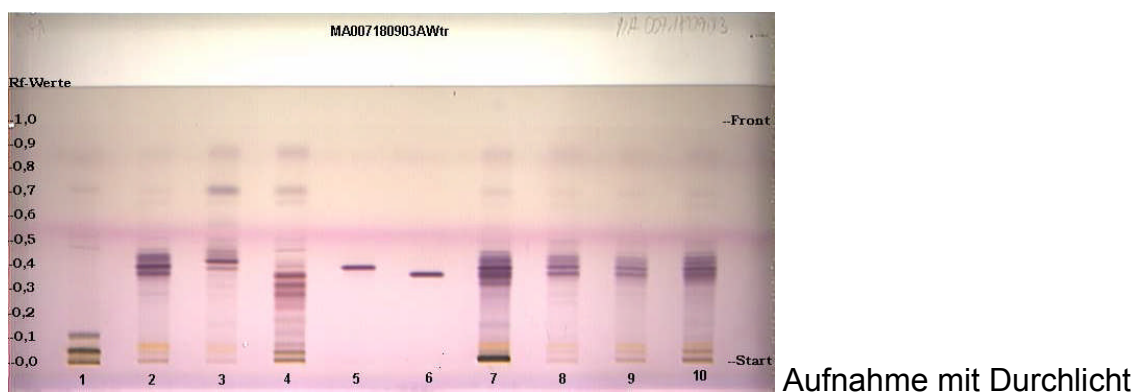
Abbildung 5-3: Selektivität des Verfahrens zur Identitätsbestimmung der Droge Traubensilberkerzenwurzelstock anhand der Triterpenglykoside; MA007-065 (Bahn 1), MA007-067 (Bahn 2), MA007-068 (Bahn 3), MA007-113 (Bahn 4), Referenzlösung Actein (Bahn 5), Referenzlösung 27-Deoxyactein (Bahn 6), MA007-066 (Bahn 7), MA007-123 (Bahn 8), MA007-124 (Bahn 9), MA007-125 (Bahn 10).
