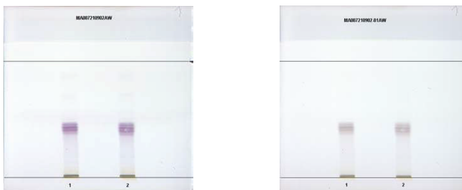
Abbildung 5-15: Vergleich der Chromatogramme nach unterschiedlich langen Wartezeiten zwischen der Derivatisierung und der Dokumentation; Untersuchungssubstanz authentische Droge (MA007-066).
