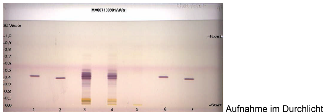
Abbildung 5-6: Selektivität des Verfahrens zur Identitätsbestimmung eines Fertigarzneimittels, das Extrakt der Droge Traubensilberkerzenwurzelstock enthält; Referenzlösung Actein (Bahn 1), Referenzlösung 27-Deoxyactein (Bahn 2), MA007-131 (Bahn 3), MA007-126 (Bahn 4), MA007-130 (Bahn 5), Referenzlösung Actein (Bahn 6), Referenzlösung 27-Deoxyactein (Bahn 7).
