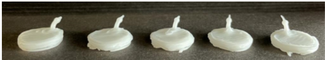
Abbildung 11: Gedruckte Arzneiformen mittels HME-3D-System, 2 cm Durchmesser, ohne Puffersystem
