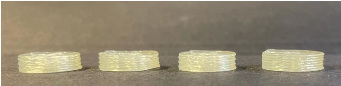
Abbildung 35: Druckversuche mit dem Schmelzextruder an der HHU mit Einsatz der Pufferfunktion zwischen den einzelnen Tabletten
