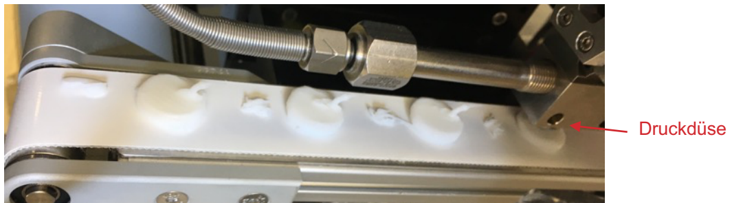
Abbildung 34: Druckversuche mit dem Schmelzextruder an der HHU ohne Einsatz der Pufferfunktion
