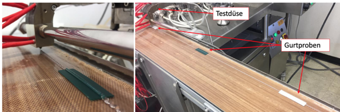
Abbildung 22: Versuche zur Haftung der Polymerschmelze an den Gurtproben
