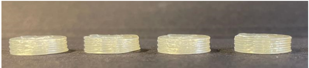
Abbildung 12: Gedruckte Arzneiformen mittels HME-3D-System, 15 mm Durchmesser, Seitenansicht
