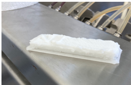
Abbildung 37: Erste Testquader mit Schmelzextruder
