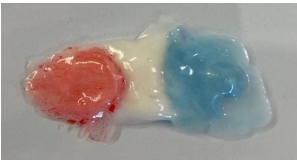
Abb. 6 Überprüfung der Phasenlage der Referenz. Mit lipophilem Sudanrot gefärbte Referenzcreme (links); mit hydrophilem Methylenblau gefärbte Creme (rechts).
