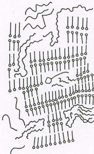
Abbildung 4-1: Schematischer Aufbau einer W/O-Absorptionsgrundlage nach Junginger 1992.
