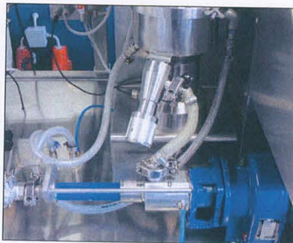
Abbildung 2-14: Ventilbereich zwischen Mischbehälter und NEMO®-Pumpe
