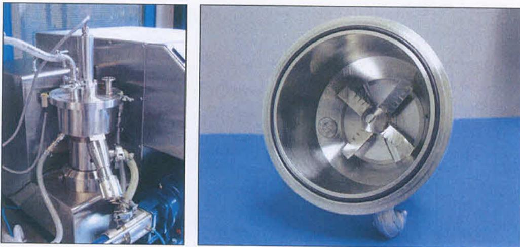
Abbildung 2-4: Außen- und Innenansicht des Mischbehälters mit Scherwerkzeug
