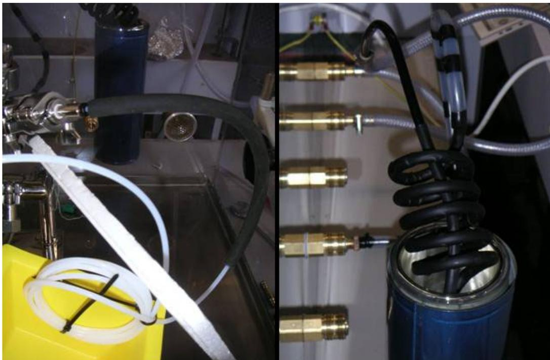
**Abbildung 7:** Entwickelte Kühlvorrichtung für das Mahlgas. Links die Kühlung der Gaszuleitung der Produktzufuhr, rechts die Kühlung des Gases für die Mahlkammer.
