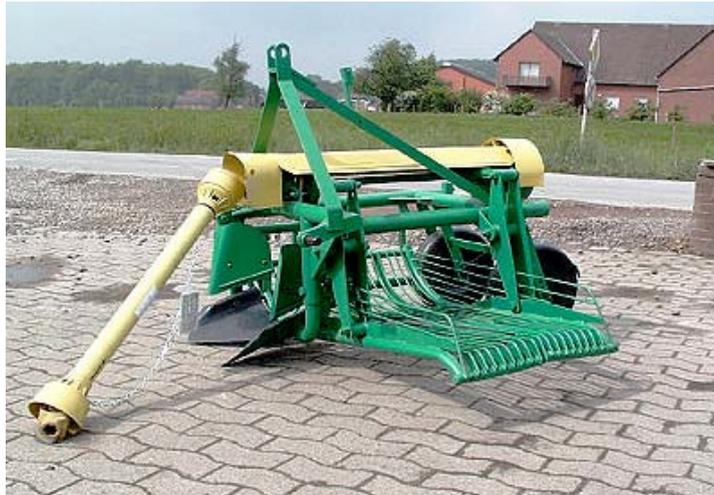
**Abbildung 23:** Schwingsiebroder, System Kuxmann (Quelle: Sikendiek Landtechnik)
