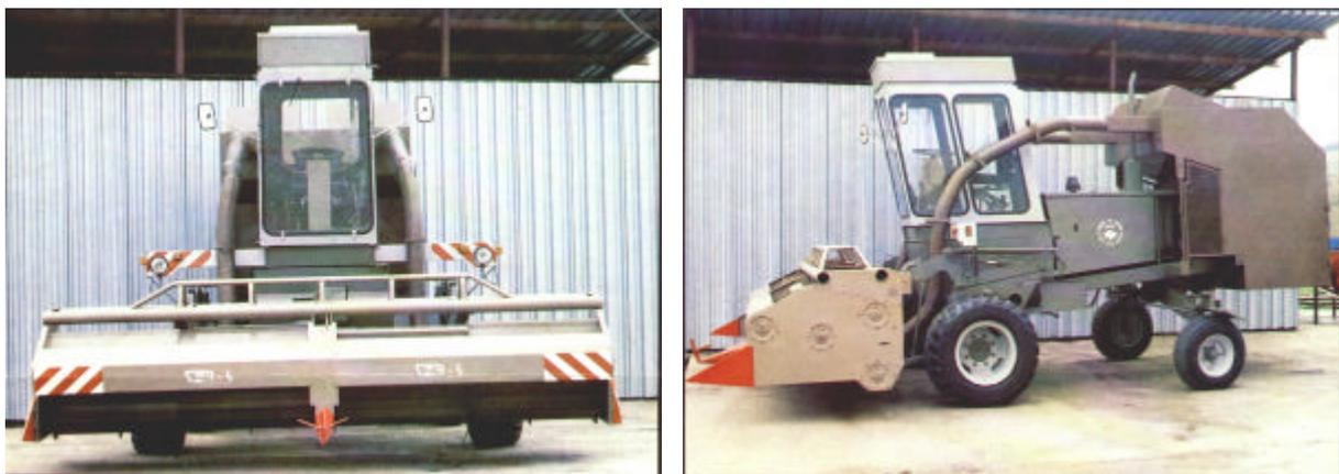
**Abbildung 10:** Selbstfahrende Kamillenpflückmaschine VZR 4 (Quelle: Rozkvet)
