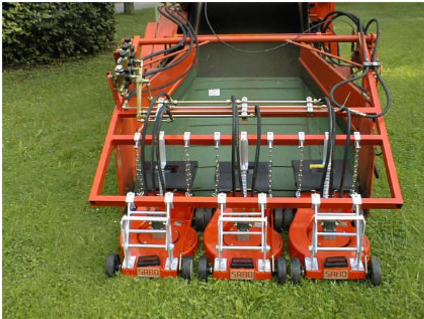
**Abbildung 20:** Mähaggregat des Bergfrauenmantelernters (Quelle: Bayerische Landesanstalt für Landtechnik)
